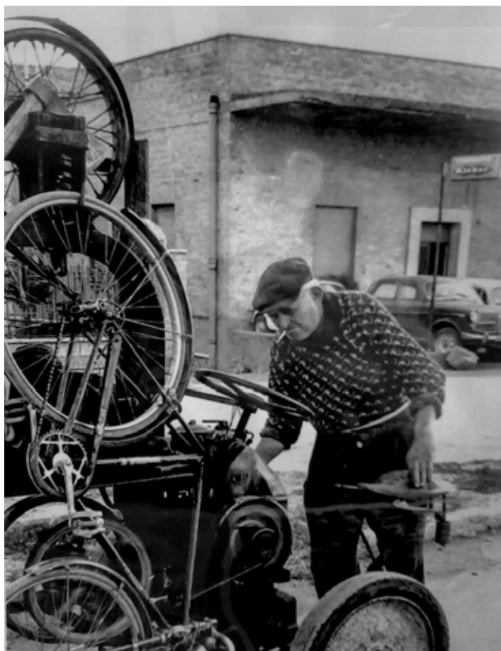
Corimbi dalla grande inventiva: aveva adattato un motore a scoppio ad una sega circolare con ruote anch'esse riciclate, il che gli permetteva non solo di tagliare la legna ma di recarsi con lo stesso mezzo nelle case del paese per lavorare a domicilio
